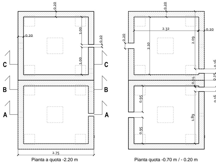
Carpenteria pianta copertura vasca interrata
