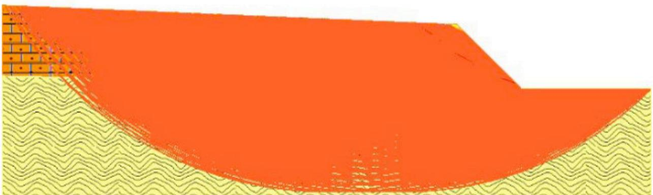
Figura 6.1 Mappa colorata delle superfici di rottura e della maglia centri
