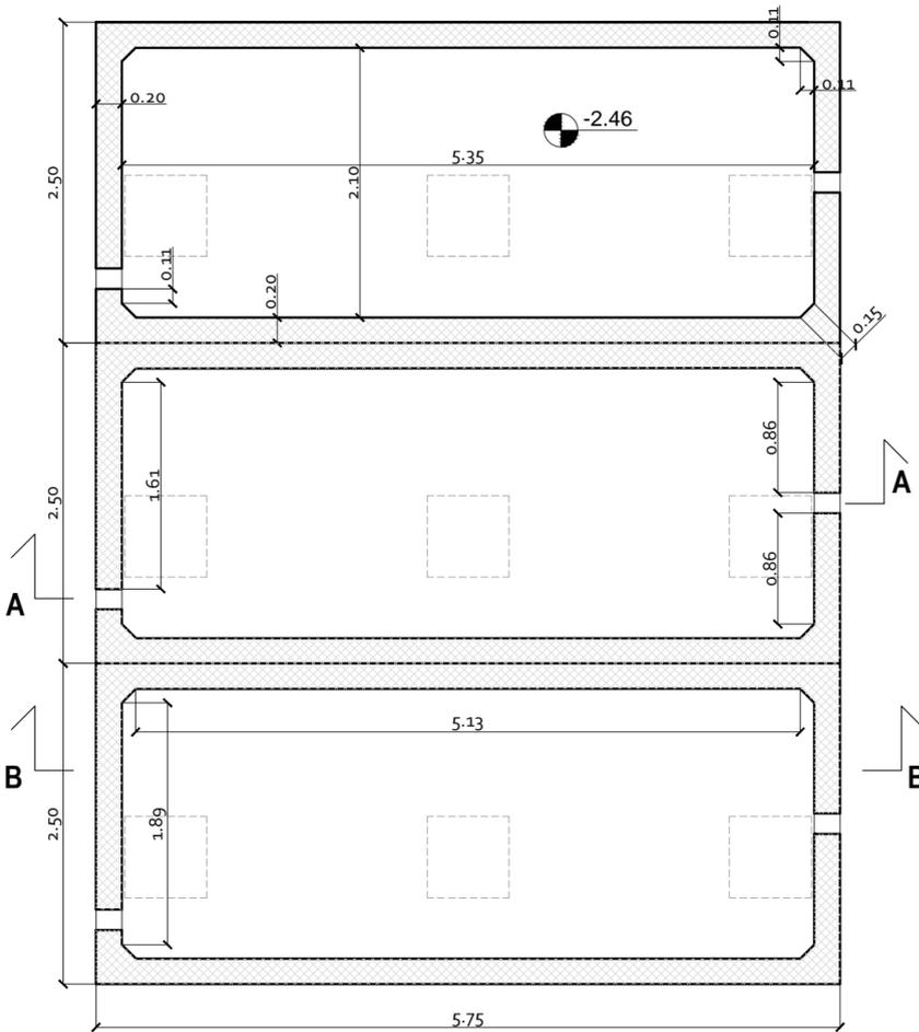
Carpenteria pianta copertura vasca interrata
